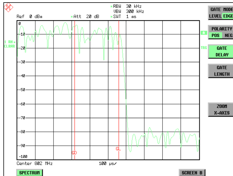
Bild 4.6 Einstellung der Zeiten GATE DELAY und GATE LENGTH im Zeitbereich mit Hilfe der Linien GD und GL
